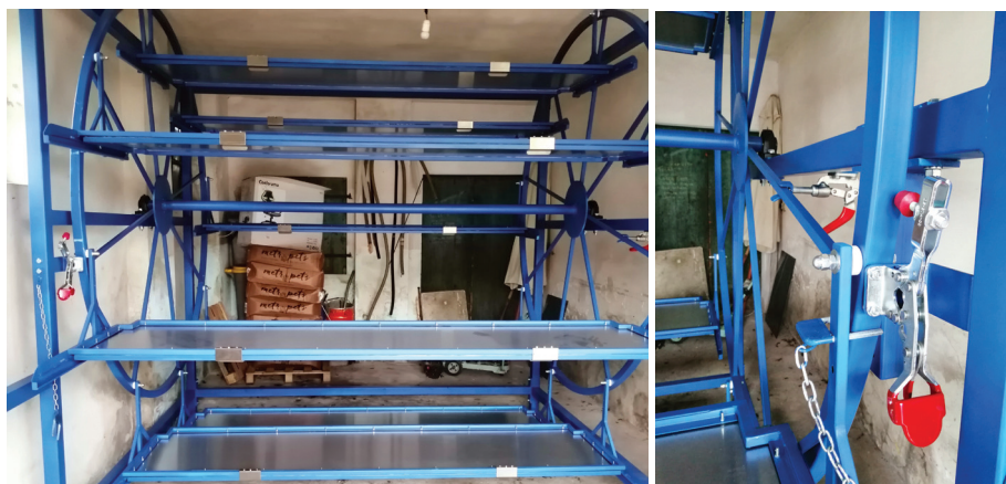
Figure 6(a) and 6(b). In ros i sistemis di sigurece montâts su la machine, frens, fer a forcje su la ruede e il telâr des casselis par che no bali cuant che si lavore, fer a forcje sul rai a cuadri de ruede par fermâ la pussibilitât che la ruede si movi cuant che si lavore suntune cassele. Su lis casselis si puedin viodi dôs cernieris par fermâ il font de cassele par che no sbrissi fûr.
