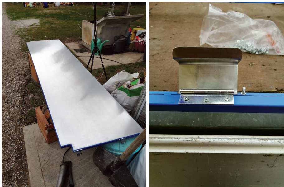
Figure 7. Particolâr de cerniere par fermâ il font de cassele in açal inossidabil cu lis ruedutis.
