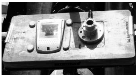
A man çampe solarimetris a cele FV, a man drete a termocubie.
