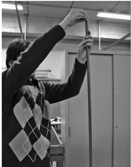
M3. Calamite in colade libare intun tubo di ram.
