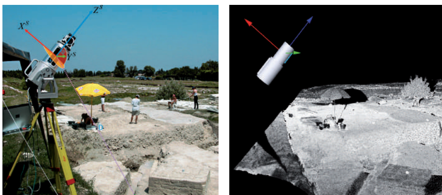
Figure 3. Il sistema laser scanner e fotogrammetrico durante l'acquisizione dei dati nelle Terme Romane (a sinistra) e il nuvola di punti 3D misurati e colorati secondo l'intensità tornata dallo strumento (a destra). / Figure 3. The laser scanner and photogrammetric system during the data acquisition in the Roman Thermae (left) and the cloud of the measured 3D points coloured by the returned intensity (right).
